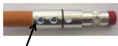
Kabel respektive Hülsen an einem Kontakt montiert
